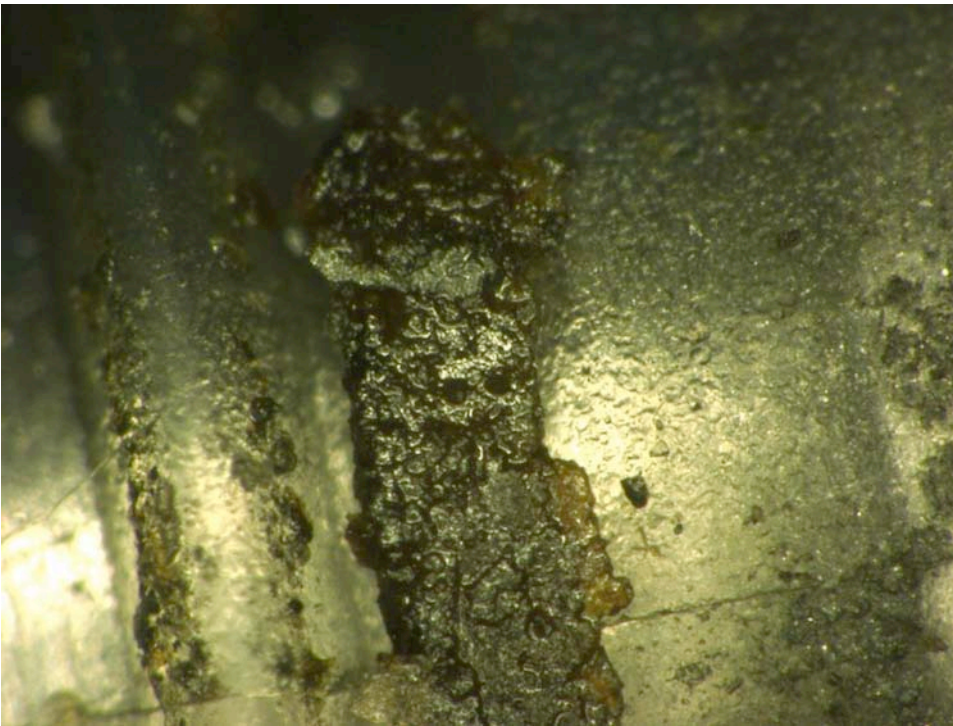
Bild 1: Blutreste an der Schubstange einer Ultraschallschere, aufbereitet von einem zertifizierten Aufbereiter.
